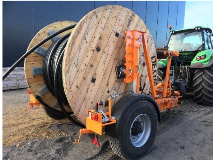
Mynd 10 Strengjakefli á keflavagni sem notað er við lagningu jarðstrengs.
